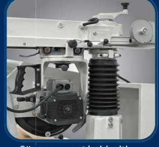
Sägeaggregat beidseitig um 45 Grad schwenkbar
