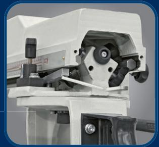
Verfahrbares Sägeaggregat mit Rückstellfeder, achtfach gelagert für präzise Schnitte
