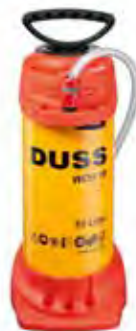
WASSERDRUCKBEHÄLTER zum wassernetzunabhängigen Bohren, Stahlbehälter, Füllinhalt 10 l, gewebeverstärkter Schlauch 2,5 m und 1/2" Kupplung mit Wasserstopp BESTELL-NR. WDB 10
