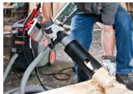
BOHREN IN HOLZ mit Staubabsaugung – handgeführt
