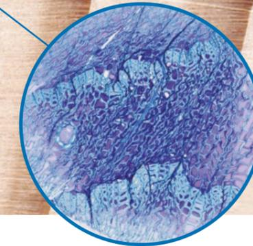
Mikroskopische Aufnahme der Verbindung zwischen dem LIGNOLOC® Holznagel und dem umgebenden Trägerholz.
