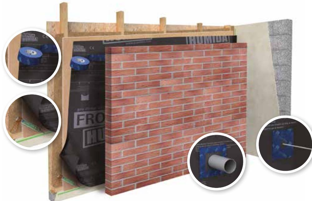
**Anwendungsbereich** Winddichtung außen, Wand, Wandschalungsbahn. Anwendung hinter belüfteten Vormauerschalen.
