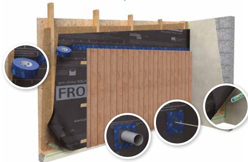
**Anwendungsbereich** Winddichtung außen, Wand, Wandschalungsbahn. Anwendung hinter geschlossenen Fassaden.
