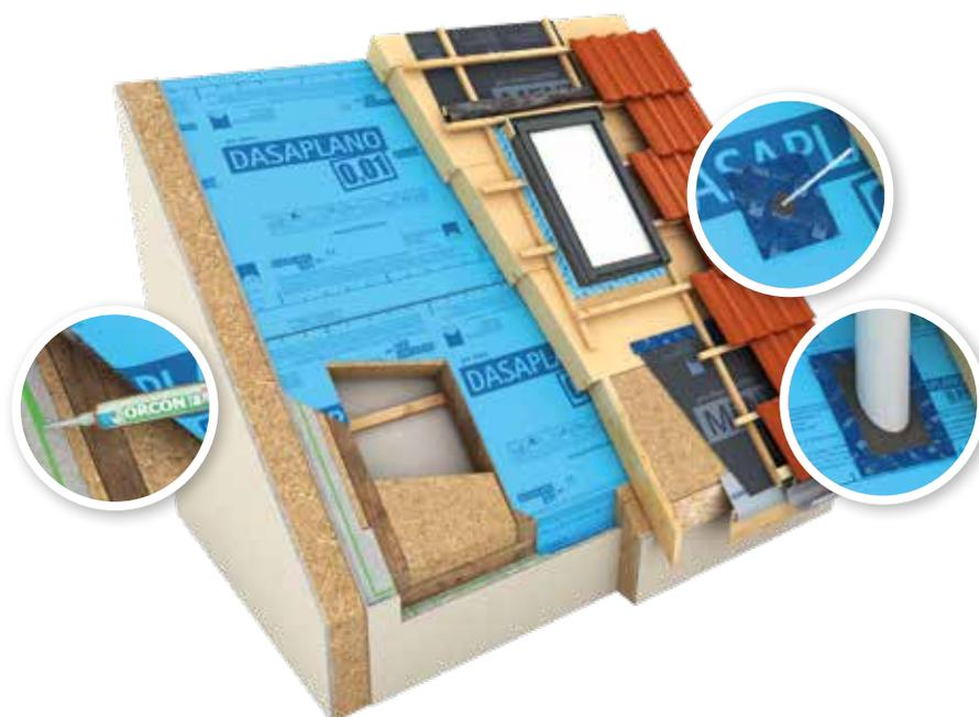
**Anwendungsbereich** Luftdichtung Einbau von außen bei Dachsanierung. Verlegung glatt über Gefachdämmung und Sparrenoberkanten.
