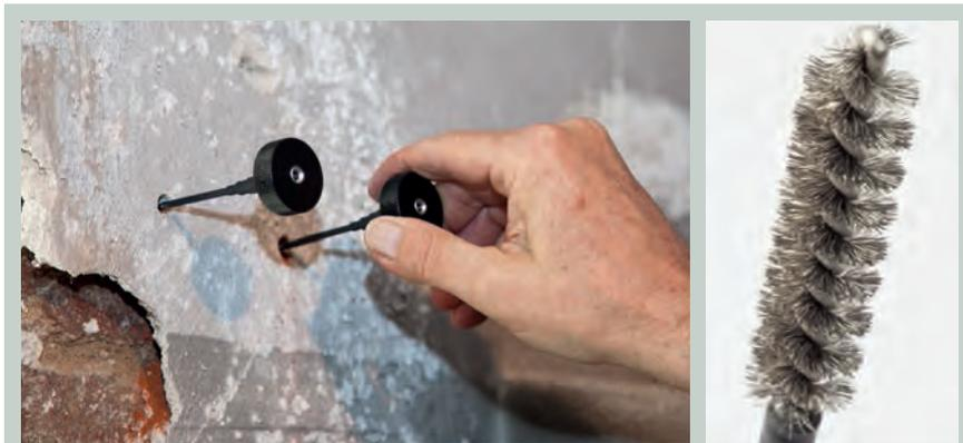
**ANWENDUNG** Die Bürsten-Elektroden werden ins vorgebohrte Loch eingedreht
