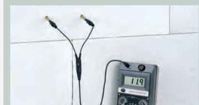
**ANWENDUNG** Messung mit einem Tiefen-Messelektrodenpaar M 21-250
