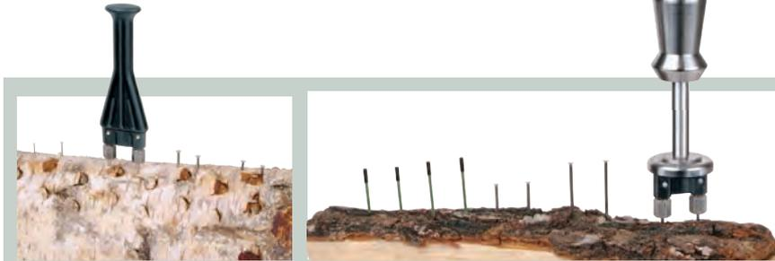
**ANWENDUNG** Verschiedene Nagellängen im Überblick: Einsatz mit den Elektroden M 20 [links] und M 18 [rechts]
