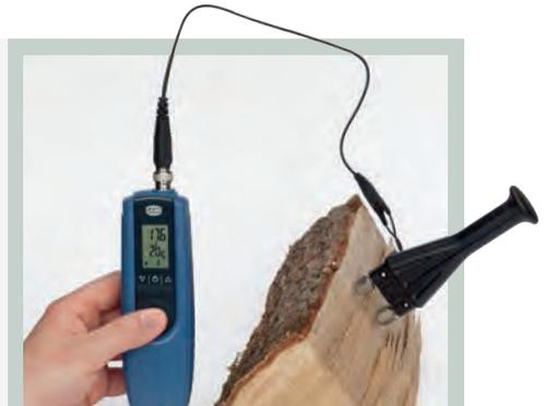
**ANWENDUNG** Feuchtemessung mit einer **M 20-Elektrode** quer zur Faserrichtung des Holzes
