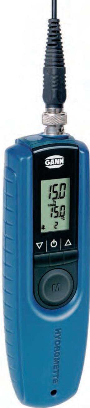
Die BL H 40 ist ein elektronischer **Holzfeuchtemesser** nach dem Widerstands-Messprinzip für Präzisionsmessungen von **Schnittholz** (bis 180 mm Stärke), **Spanplatten** und **Furnieren**. Zusätzlich wird über die einstellbare **Holztemperatur-Kompensation** eine Optimierung des Messwertes erreicht. Besonders geeignet ist dieses Messgerät für Schreinereien, Parkettverleger und Maler.
