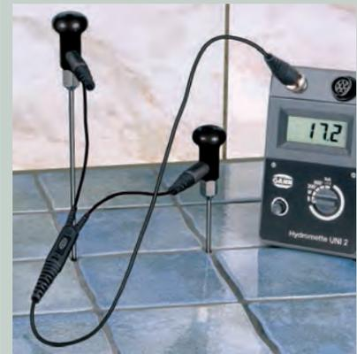
Einsatz mit der Einsteck-Elektroden M 6 oder der Einschlag-Elektrode M 20 mit folgenden Geräten:
